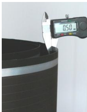
De dikte van Powerfoil® van slechts 0.5 mm geeft het product zijn flexibele eigenschappen
